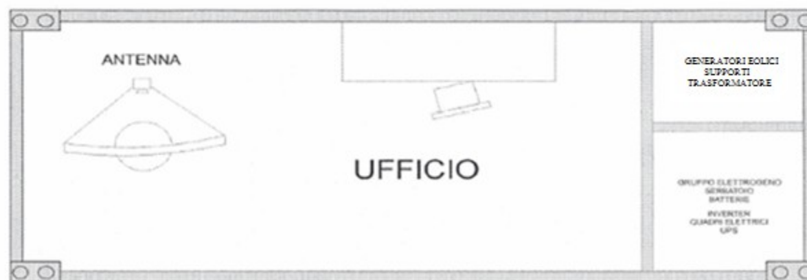
SHELTER DI CENTRALE FOTOVOLTAICA IN CONDIZIONE OPERATIVA
